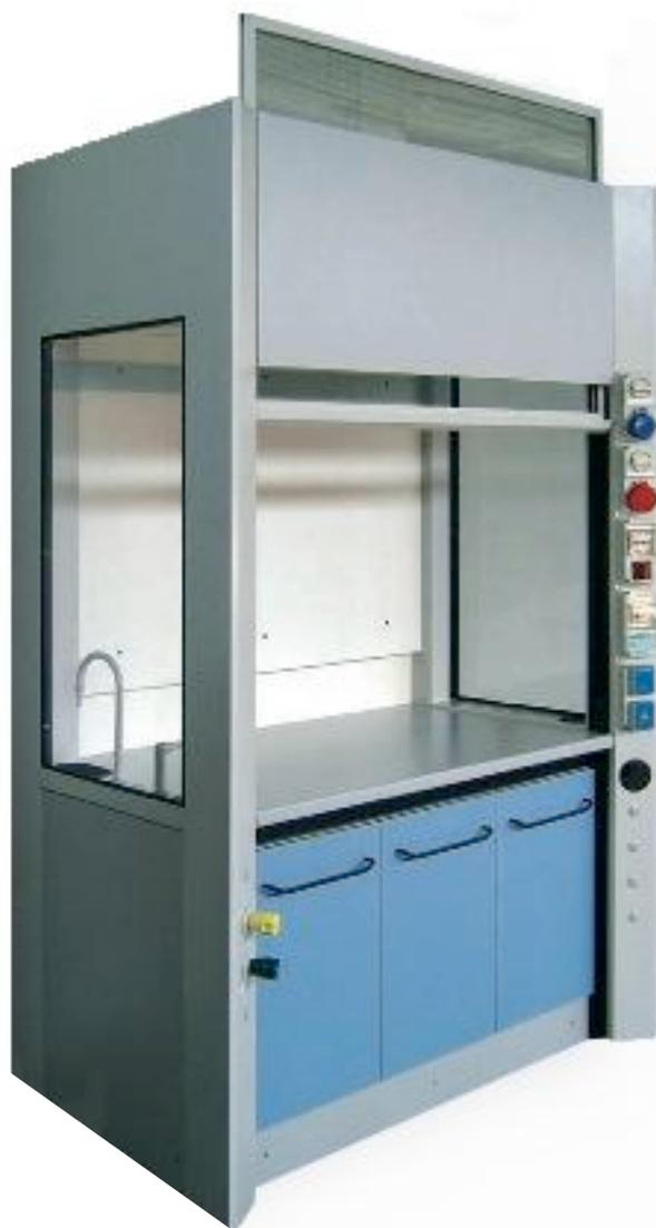
La cappa da laboratorio è una cella nel cui interno, mantenuto in depressione mediante un'aspirazione dell'aria, vengono eseguiti dei processi chimici pericolosi impiegando reagenti che, per reazione tra loro, diventano tossici/nocivi/infiammabili e vengono espulsi attraverso un condotto o riciclati previo adeguata filtrazione.
